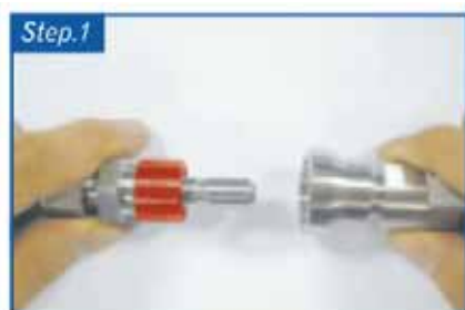
Расположите тело и штуцер на одной оси
