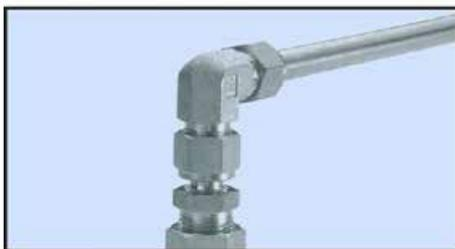
4. Установите угольник с фитингами на адаптер и трубку. Отрегулируйте необходимый угол и зафиксируйте его, закрутив гайку фитинга.
